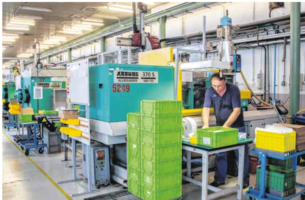
Az ADS jelenleg 19 korszerű fröccsöntő géppel gyártja a műanyag termékeket – tudtuk meg Lovas Róbert ügyvezető-igazgatótól.
